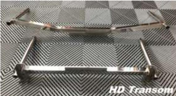
Im Gegensatz zum standardmäßigen Transom aus Rundrohren besitzt das Heavy-Duty Transom Querrohre aus 2mm dickem Quadratrohr. Die Längsrundrohre bestehen aus 1,2mm dicken Rundrohren und sind kompatibel mit den Angelrutenhalterungen. Das Material ist ebenfalls Edelstahl 304, d.h. im Salzwasserbetrieb müssen sie mit Frischwasser gespült und
