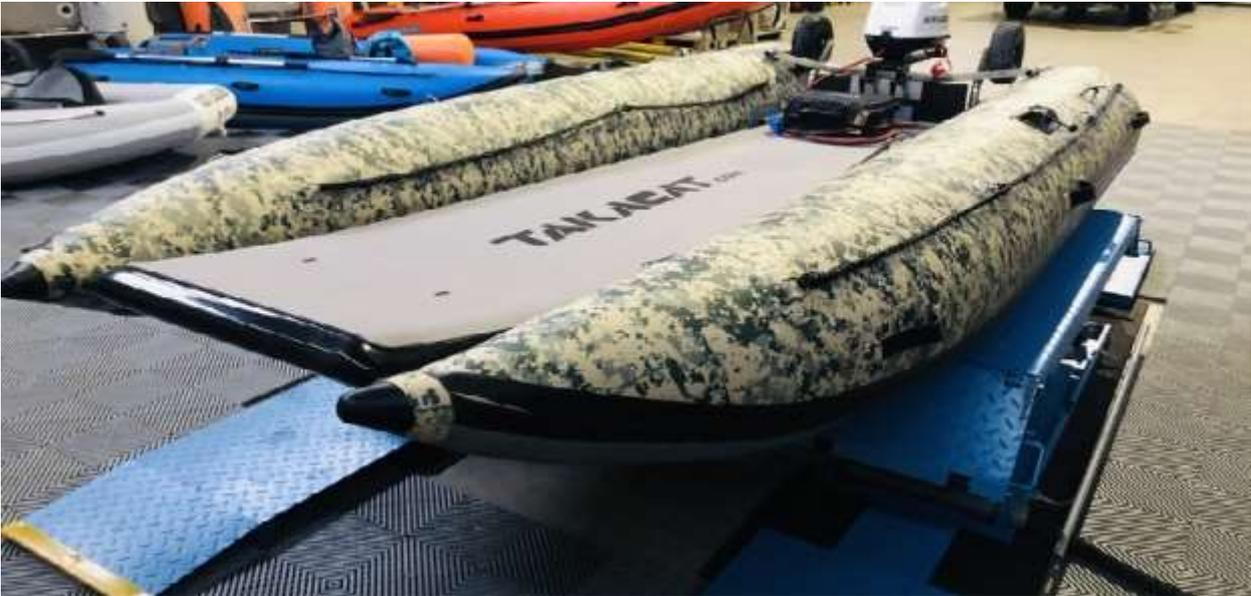
Der „Wave-Piercer“ Speed-Schlauch wird im aufgeblasenen Zustand unter dem Verbindungsboden an den Ringen der Bugfixierung und an der unteren Transomstange am Heck befestigt.
