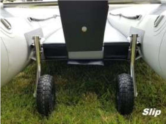
Das optionale Schnellspann-Rad-System (QRW) ist Teil des komplett zerlegbaren Heckspiegels von TAKACAT. Mit Hilfe der Slip-Räder können Sie Ihr TAKACAT einfach und bequem vom Auto oder vom Campingplatz ins Wasser hinein und wieder herausfahren, ohne es tragen zu müssen. Die Slip-Räder werden einfach eingesteckt. Das Gewicht des TAKACAT wird durch die Slip-Räder nicht signifikant verändert. Sie müssen weder bohren
