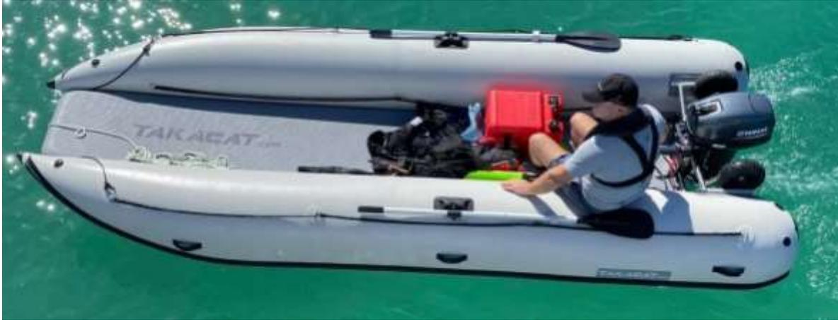
Der neue "Heavy-Duty" Hochdruckboden besitzt, im Gegensatz zum standardmäßigen Hochdruckboden, eine doppelte PVC-Schutzlage auf der Oberseite (2 x 1mm) und einen ganzflächigen PVC-Schutzbelag (1mm) auf der Unterseite. In Verbindung mit dem umlaufenden PVC-Schutzbelag (1mm) ist der HD-Hochdruckboden allseitig gegenüber Impakts geschützt, wesentlich härter in seiner Struktur und eine faltbare Alternative zum GFK-Boden.
