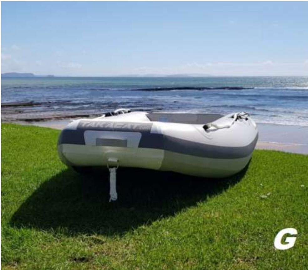
Im Gegensatz zum TAKACAT-L besitzt das TAKACAT-G zusätzlich zu dem geschlossenen Heckspiegel auch einen geschlossenen Rumpf. Die G-Modelle können mit einem Außenborder bis 5PS (T240G) und 8PS (T280G) motorisiert werden. Auch bei den beiden G-Modellen sind beide Fahrschläuche am Heck jeweils mit einem Überdrucksicherheitsventil ausgestattet. Im unteren Bereich der Heckspiegelplatte ist zusätzlich ein Lenzventil installiert.
