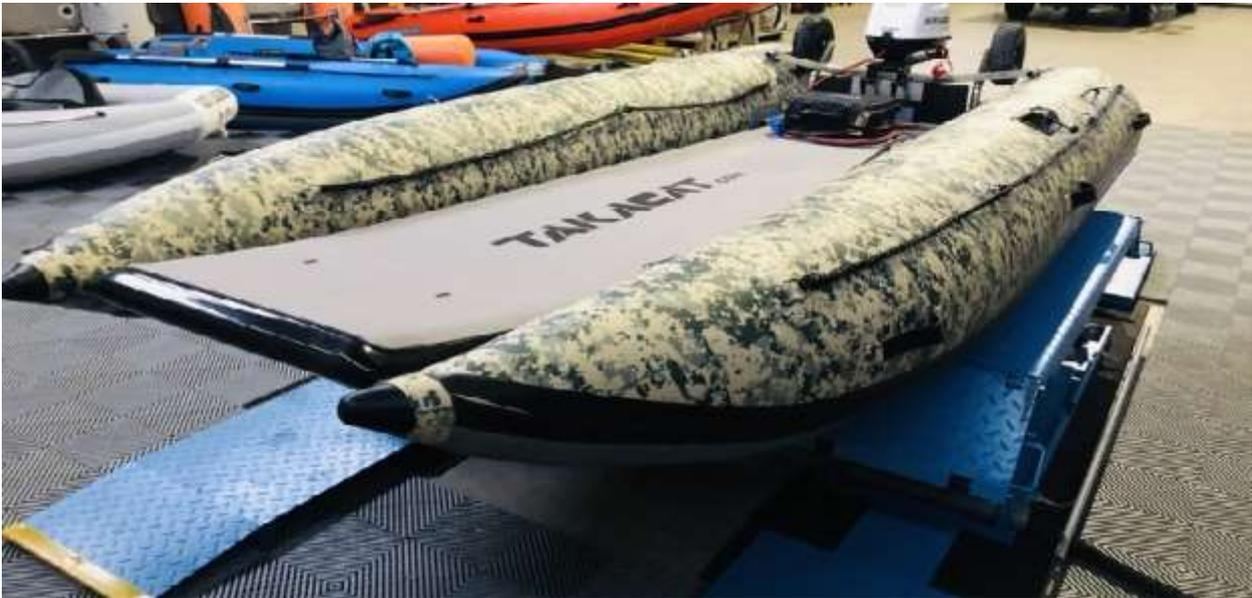
Der neue RIB-Boden aus GFK bietet die Möglichkeit ein Takacat LX in einen RIB-Katamaran mit einem festen Innenboden zu verwandeln. Auf dem GFK-Boden können Sitze, Konsolen und auch komplette Jokey-Konsolen montiert werden. Im Gegensatz zu anderen RIB-Katamaranen kann das gesamte Boot zerlegt werden. Dadurch kann das Boot wesentlich kompakter eingelagert werden. Der RIB-Boden aus GFK ist für die LX-Modelle 340LX, 380LX und 420LX erhältlich.
